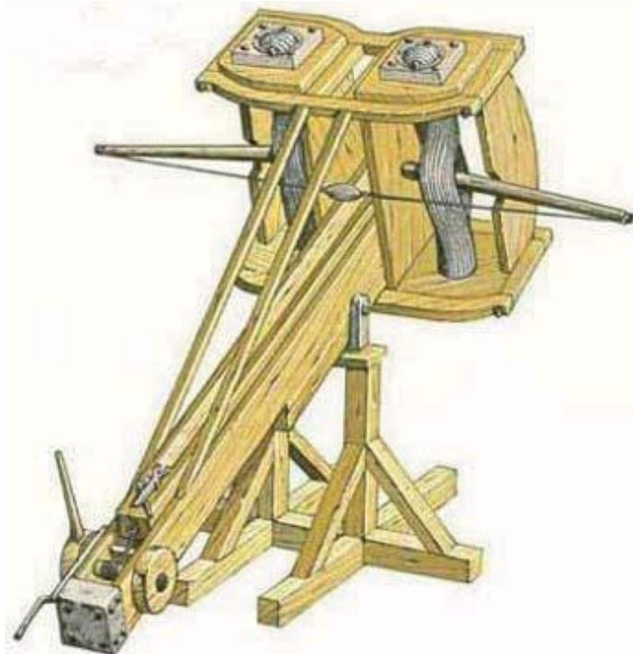
Balista romana como las que usaría Pompeyo y sus legados para someter las fortificaciones. Lanzaban proyectiles esféricos de piedra con un peso que solía rondar entre los 3 y los 26 kilos y un alcance estimado en un par de cientos de metros.
